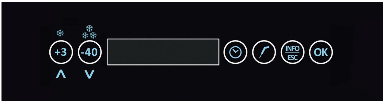
Les modèles sont dotés d'une carte électronique de puissance « Compact » et d'affichage mécanique « Glass ». L'interface utilisateur est dotée d'un afficheur LED à 6 chiffres avec visualisation par défilement et également de 6 boutons mécaniques comme suit :
